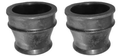
Mufy gumowe łączące filtr na zbiorniku z kolektorami dolotowymi
