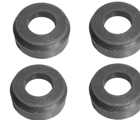
Gumowe poduszki mocowania tyłu zbiornika paliwa do ramy
